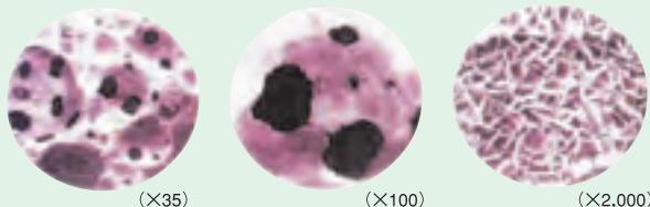
ケイ酸(ケイ石)とカルシウム(生石灰)を化学反応させた人工骨材(トバモライト水和物)のCO-OPエースは平成5年に商品化して以来、12年がたちました。吸湿、排湿能力は様々ですが、実証しています。
