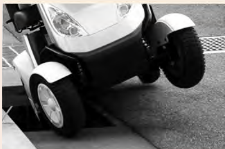
電動車いすが側溝で脱輪
